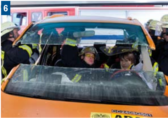
Abheben des Fahrzeugdachs
