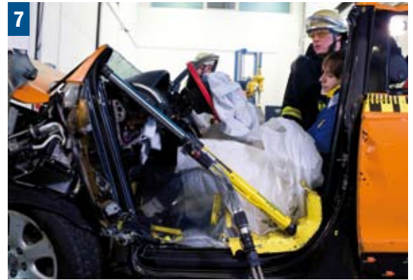
Erweitern des Fußraums durch Rettungszylinder
